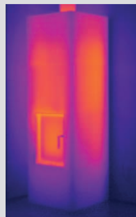
12 hod. od zakúrenia priemerná teplota povrchu 45 °C
